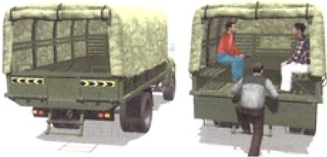
Батлан хамгаалах зориулалтын ачааны автомашины суудал засаж тоноглогдсон тэвш
